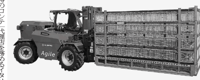
通常のフォークリフトよりも低車高の「アジャイル」
