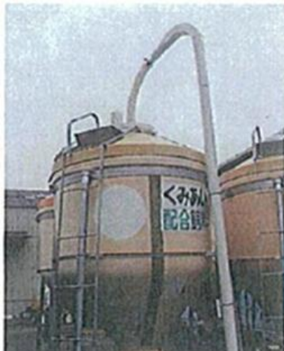
エアー搬送によるタンクへの米投入
