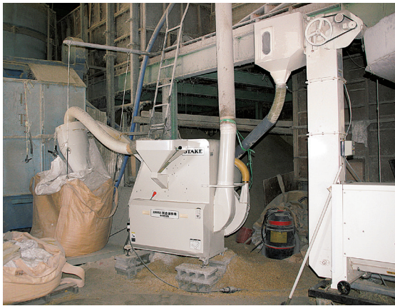
㈱大竹製作所の飼料用 米脱皮・破碎機 (SDH35) 1台約100万円
